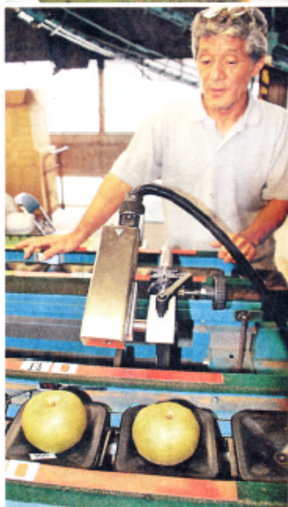
選果ラインに組み込まれたインクジェットプリンター(香川県豊後町で)
